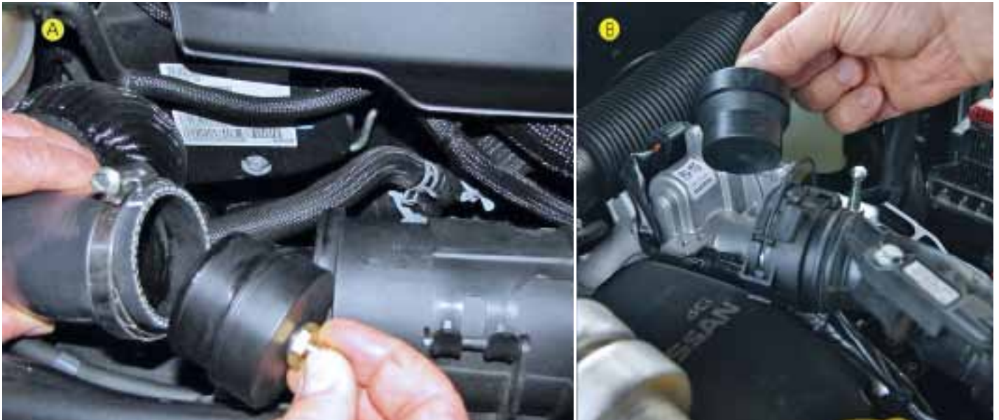
Fig. 3. Les deux versions de bouchons: A pour la fixation (classique) au moyen de colliers de serrage de flexible, B pour la fixation au moyen d'une fermeture emboîtable.
