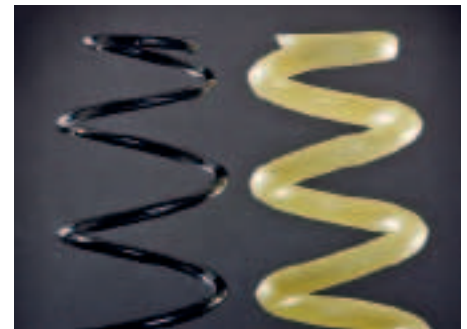
Fig. 6. Comparaison entre un ressort hélicoïdal en acier et une version en matériau composite.
