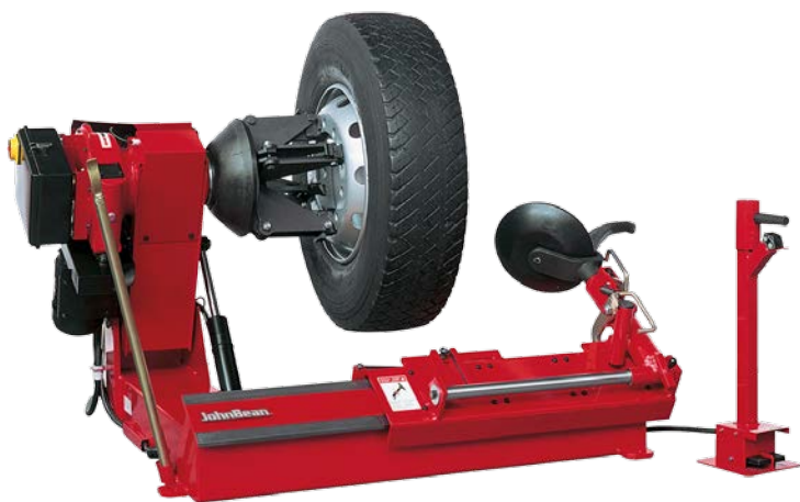
Démonte-pneus T8026 pour jantes de camions de 13 à 26 pouces.
