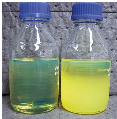
Fig. 4. Diesel d'hiver (à g.) et diesel d'été (à dr.) refroidis à une température de -20^\circ\text{C} → Dans le cas du diesel d'été, la paraffine s'est séparée du carburant et elle décanche.
