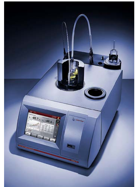
Fig. 5. Appareil de test automatique pour déterminer le CFPP.
