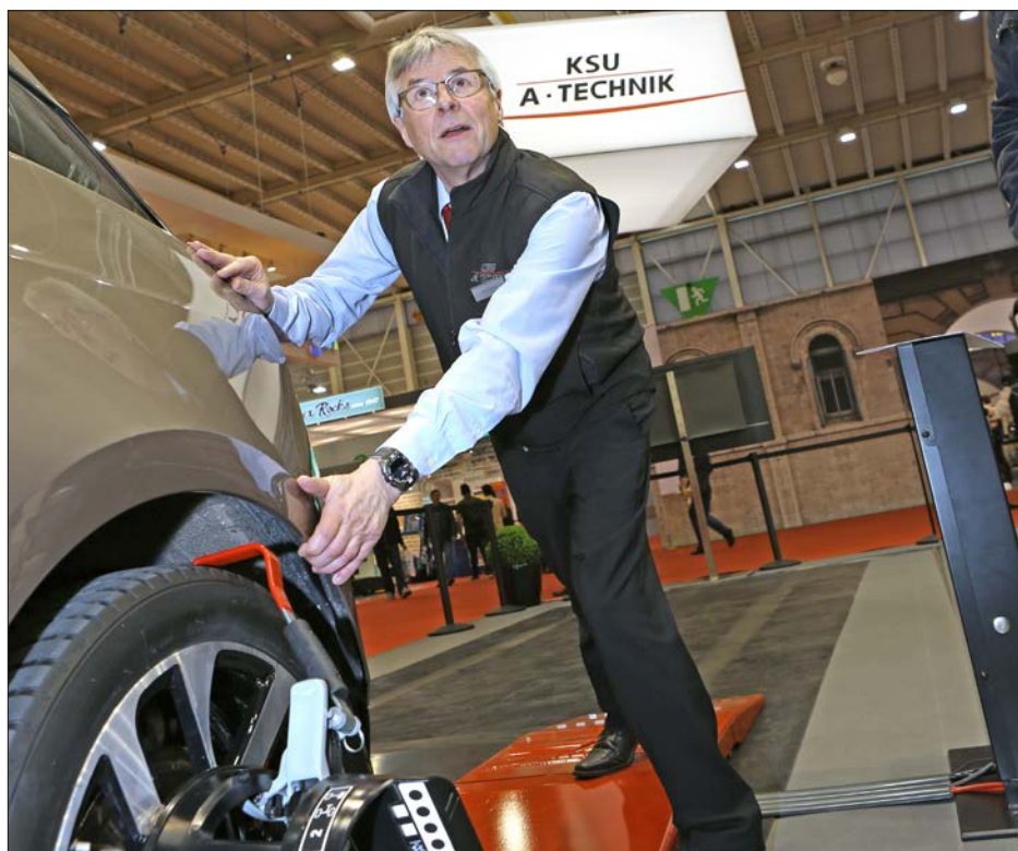
Heinz Borel présente un nouveau système d'alignement des essieux avec mesure de sculpture sur passage du véhicule.
