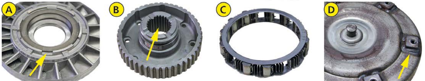
Fig. 4. Points faibles des convertisseurs de couple : A Bague extérieure desserrée de la roue libre, B Jeu dans la denture du disque d'entraînement, C Ressorts et rouleaux dans la roue libre endommagés, D Fissures (suivies de fuites) au niveau des soudures.
