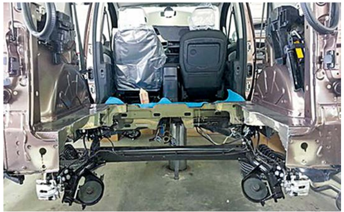
Kangoo en cours de transformation : décaissage d'un Renault Kangoo afin d'y adapter le système pour transporter une personne en chaise roulante.
