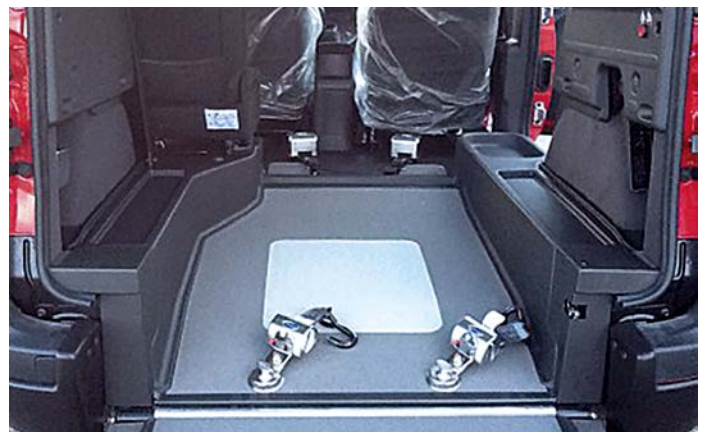
Kangoo fini : une rampe permet d'accéder à la partie arrière du Kangoo transformé pour recevoir une chaise roulante. Notez les points d'ancrage pour la chaise roulante.
