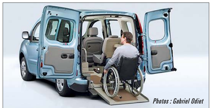
Kangoo : une personne en chaise roulante peut accéder de façon autonome à l'arrière d'un Renault Kangoo.
