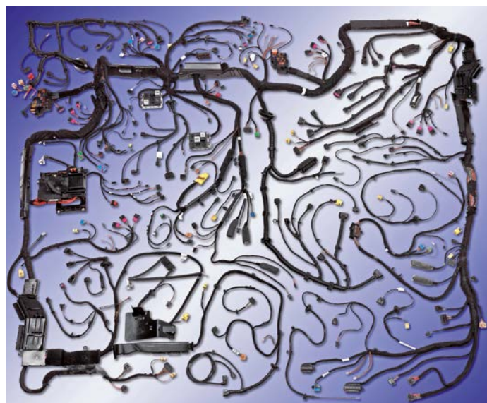
Fig. 1. Un faisceau de câbles d'une voiture de classe supérieure pèse environ 45 kg et se compose de câbles électriques pouvant atteindre une longueur de 3 km. Même des variantes simples présentent encore une longueur totale de 1,5 km et affichent sur la balance un poids de 20 kg.
