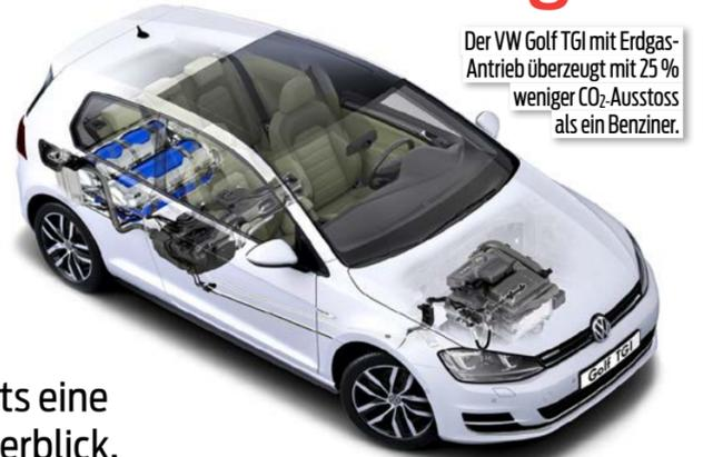
Der VW Golf TGI mit Erdgas-Antrieb überzeugt mit 25 % weniger CO<sub>2</sub>-Ausstoss als ein Benziner.
